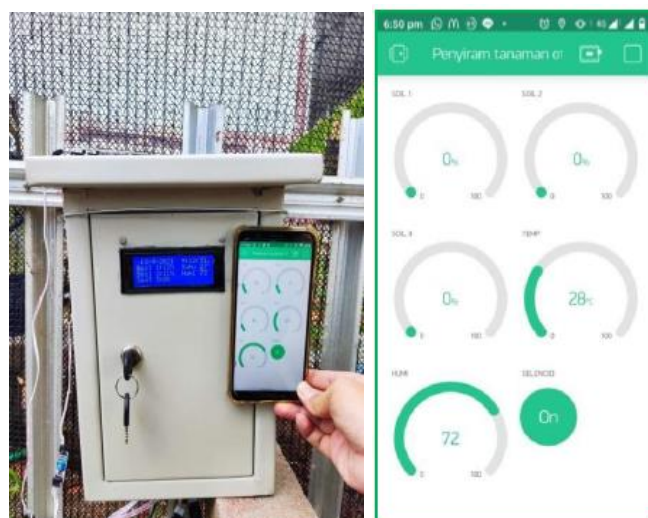
Gambar 8. Panel kendali dan tampilan pada sistem penyiram tanaman otomatis berbasis IoT yang diusulkan
