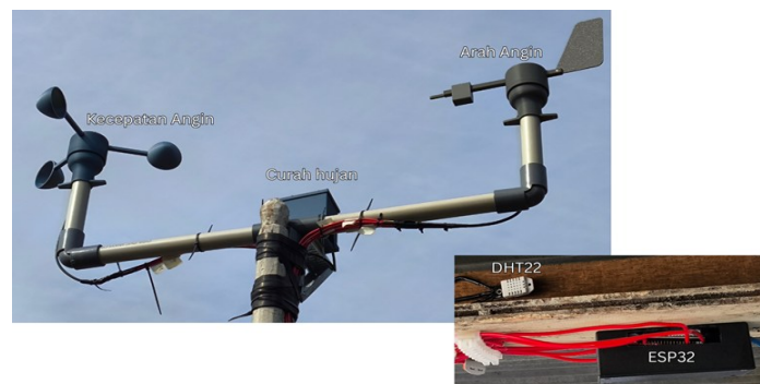
Gambar 2. IoT pemantauan cuaca yang dipasang di lapangan
