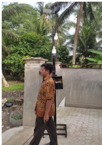
Gambar 2. Lampu jalan otomatis memanfaatkan turbin angin sebagai penerangan
