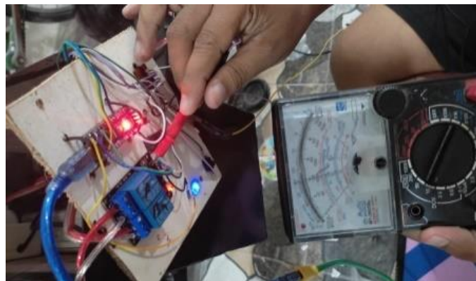
Gambar 4. Pengujian arduino dengan relay 2 channels
