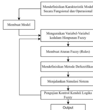
Gambar 2. Langkah pengembangan sistem kontrol kendali logika fuzzy
