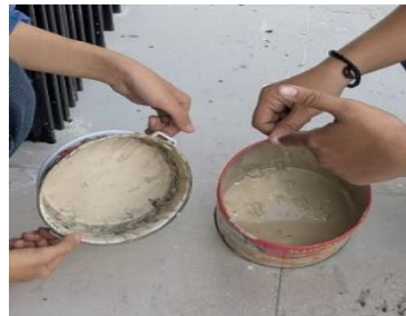
Gambar 1. Hasil peleburan plastik HDPE
