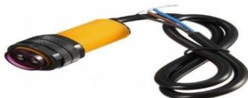
Gambar 2. Sensor Infrared Proximity *Infrared Proximity* Sensor E18-D80NK adalah sensor inframerah dengan keahlian mampu mendeteksi objek pada jarak yang cukup jauh dari 3 – 80 cm[13], dan sensor infrared proximity untuk mendeteksi ada atau tidaknya suatu objek. Bila objek berada di depan sensor dan dapat terjangkau oleh sensor maka output rangkaian sensor akan berlogika “1” atau “high” yang berarti objek “ada”. [14].
