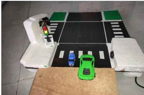
Gambar 12. Pengujian Alat Sebelum Mendeteksi Kondisi Output setelah pengendara melewati zebra cross adalah, lampu merah menyala, sensor ON (mendeteksi), buzzer ON (berbunyi), Camera ON (Menangkap Gambar).
