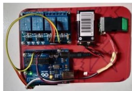
Gambar 5 Hasil perakitan keseluruhan alat
