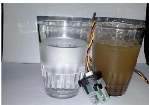
Gambar 13. Pengujian Turbidity Sensor pada air jernih dan keruh
