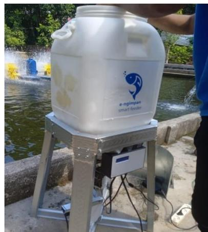
Gambar 15. Tampilan alat pakan dan pengujian dilokasi
