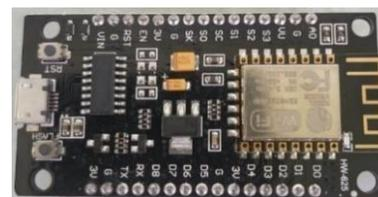
Gambar 1. Nodemcu Esp8266
