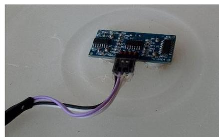
Gambar 11. Sensor Ultrasonic pada wadah pakan.
