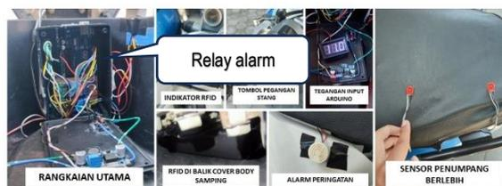
Gambar 8. Pemasangan Sistem Pada Sepeda Motor Honda Scoopy FI 2016
