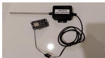
Gambar 3. Perakitan Sensor pH Tanah dengan ESP32
