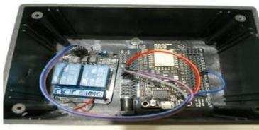
Gambar 4. Perakitan Relay 2 Channel dengan ESP32
