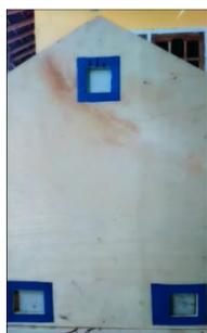
Gambar 7. Ventilasi Oven Penguningan Daun
