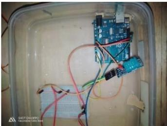
Gambar 3. Sensor DHT11
