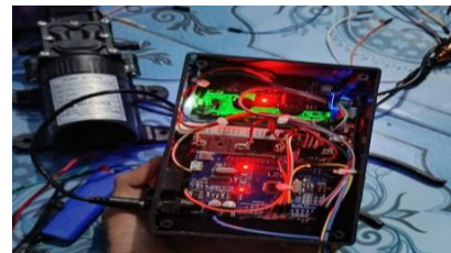
Gambar 7 Instalasi Box Kontrol
