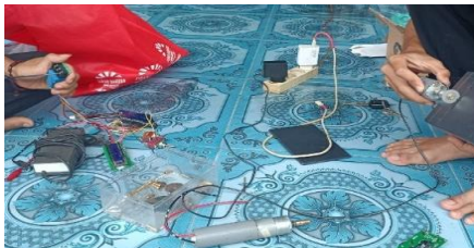
Gambar 5 Perakitan Box Kontrol
