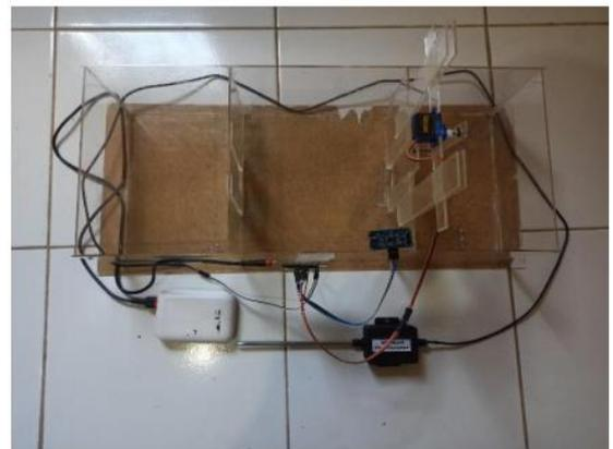
Gambar 6 Rangkaian keseluruhan Prototype Box persegi panjang yang digunakan berukuran 20 x 17 cm di gunakan sebagai lahan Prototype yang memiliki 3 bagian yaitu penampungan, wadah utama, dan pembuangan air dimana wadah penampungan air tempat di isinya air untuk mengalirkan air ke wadah utama agar sensor ultrasonik mendeteksi ketinggian air pada wadah utama sedangkan wadah pembuangan tempat dimana air yang akan dikuras pada wadah utama.
