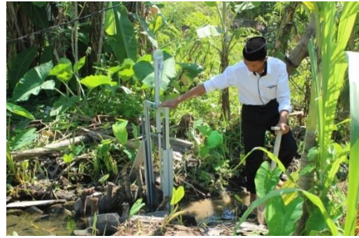
Gambar 5. Pintu Air dan Tuas pendorong
