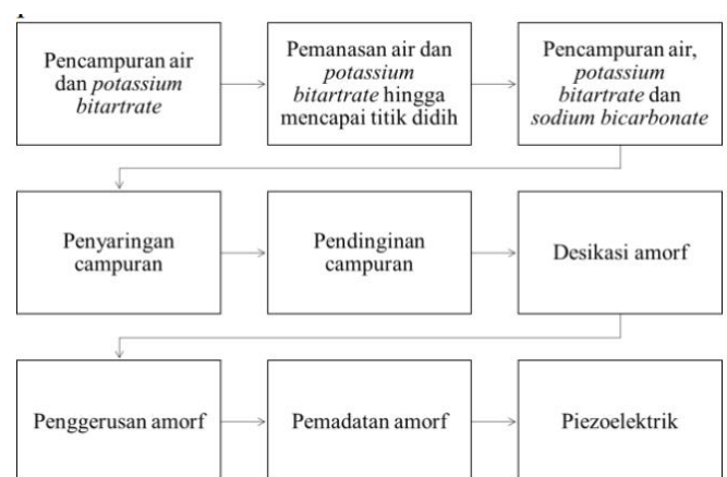
Gambar 1. Alur Pembuatan Padatan Piezoelektrik
