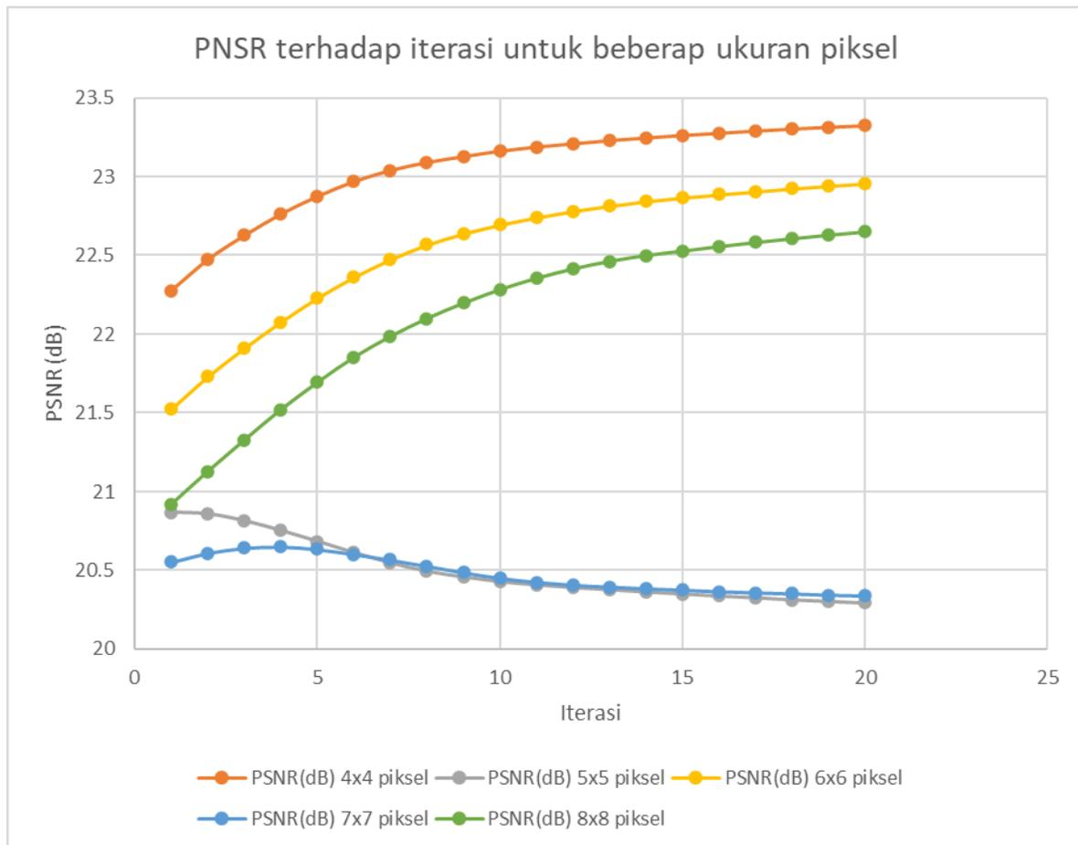
Gambar 6. Grafik perubahan PSNR berbagai piksel dengan iterasi 20 kali
