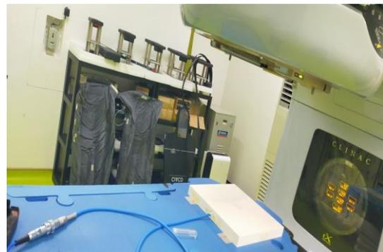
Gambar 1. Slab fantom dengan detektor
