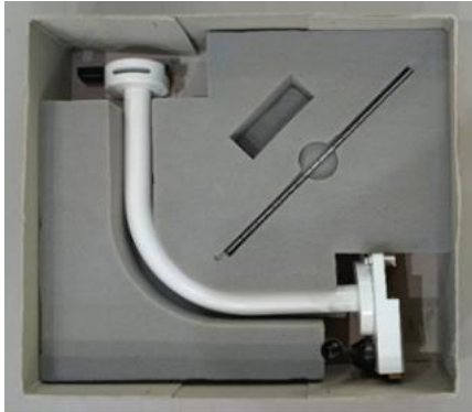
Gambar 2. Alat Ukur ODI (Instalasi Onkologi Radiasi RSUP Persahabatan, 2024)
