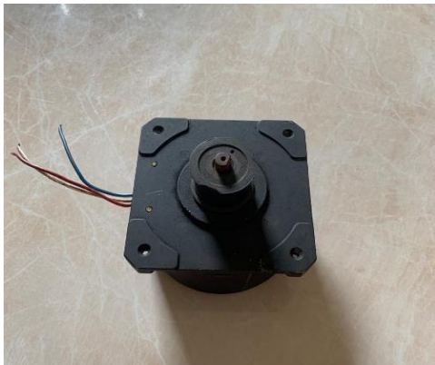
Gambar 4. Generator mini 3 fasa
