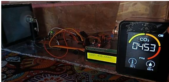
Gambar 5. Perbandingan nilai hasil pengukuran menggunakan prototype dan alat standar pada udara ruangan normal.
