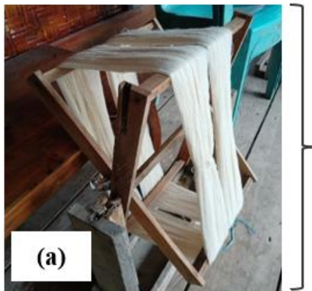
Gambar 3. (a) Alat pemintal benang kabukul , (b) diagram untuk analisis konsep momen gaya pada alat kabukul .
