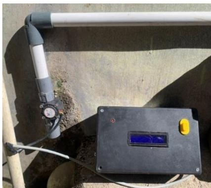
Gambar 15. Alat yang sudah terpasang pada pipa pelanggan PDAM
