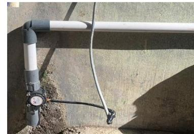
Gambar 12. Pengujian alat pada pipa PDAM System pengujian *waterflow* sensor adalah dengan cara memasang *waterflow* sensor pada pipa PDAM pelanggan
