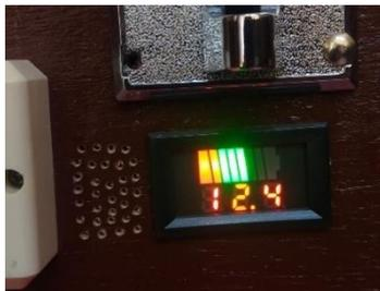
Gambar 11. Voltmeter Baterai
