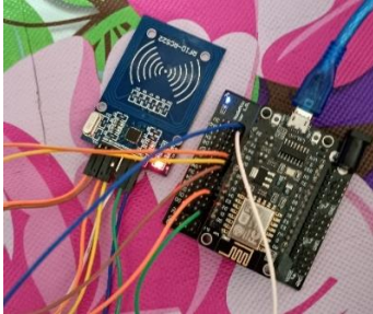
Gambar 9. Rangkaian RFID dengan NodeMCU ESP8266
