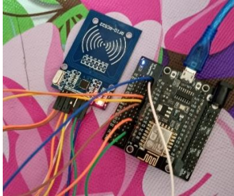
Gambar 9. Rangkaian RFID dengan NodeMCU ESP8266
