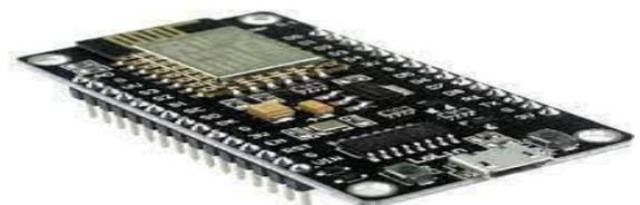
Gambar 4: Modul NodeMcu Esp8266
