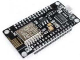
Gambar 1. NodeMCU ESP8266
