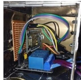
Gambar 10. Pemasangan ESP8266 dan Relay DC
