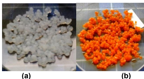
Gambar 1. Morfologi beads sebelum (a) dan setelah (b) enkapsulasi kurkumin
